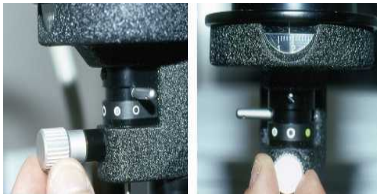
Figure 17 : la molette permet de régler la hauteur de la fente lumineuse (a), et le vernier indique cette hauteur en millimètres et dixièmes de millimètre (ici 1,75 mm) (b) [21]
