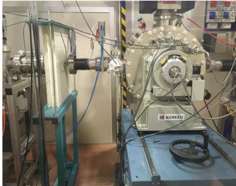
Figure 25 – Dispositif expérimental d'un monochromateur de dernière génération sur la ligne de faisceau XAFS d'ELETTRA [65].
