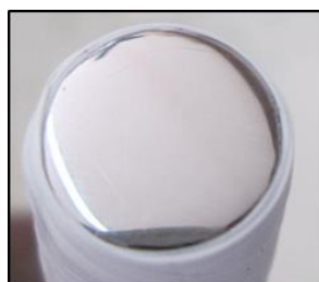
Image 5 : Photographie de la surface de l'acier C38 après le prétraitement.
