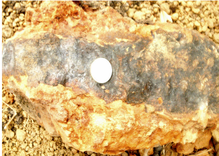
Pyroxénite altérée du Groupe de Yaoundé (épaisseur maximale du cortex : 10 cm) ; composition minéralogique : hématite, maghémite goethite, kaolinite, anatase, gibbsite, quartz.
