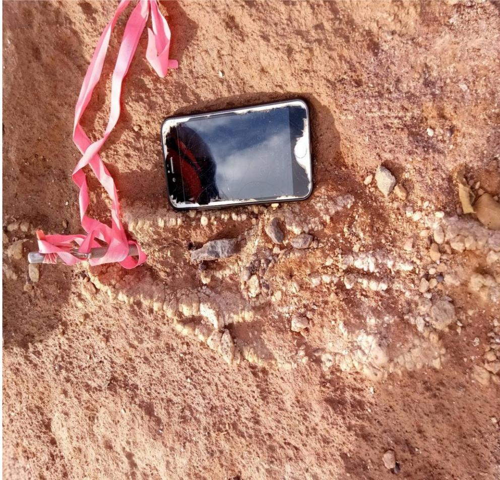
**Figure 20** : Demantèlement d'un filon de quartz minéralisé en rutile dans le niveau nodulaire médian.
