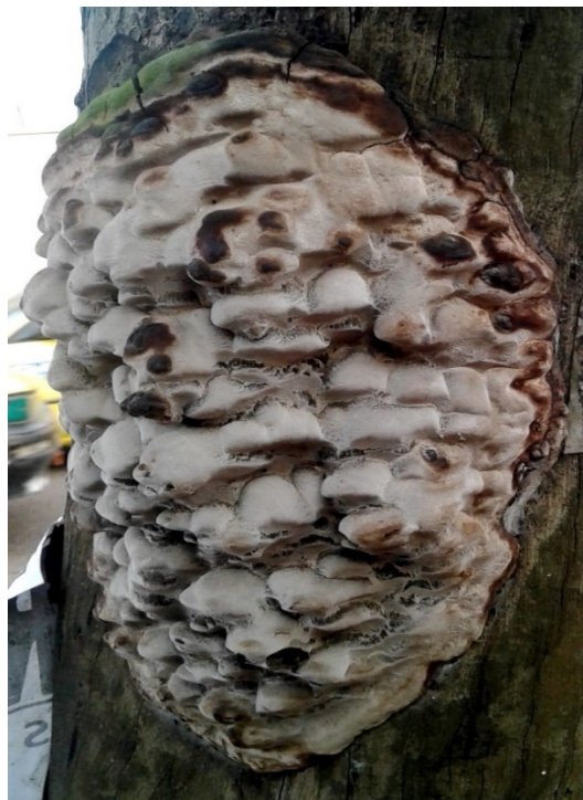
Fig. 27. DM 997 : Perenniporia tephropora . Carpophore causant pourriture blanche sur poteau électrique en Eucalyptus .
