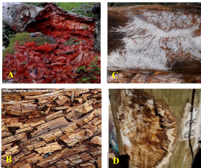
Fig. 5. Différents types de pourriture causée par les champignons lignivores sur le bois : A/B. Pourriture brune (ou cubique) (Fatton, 2014) ; C. Pourriture blanche (Pillot, 2013) ; D. Pourriture blanche causée par Perenniporia tephropora sur poteau électrique à Yaoundé (Kabika, 2020).
