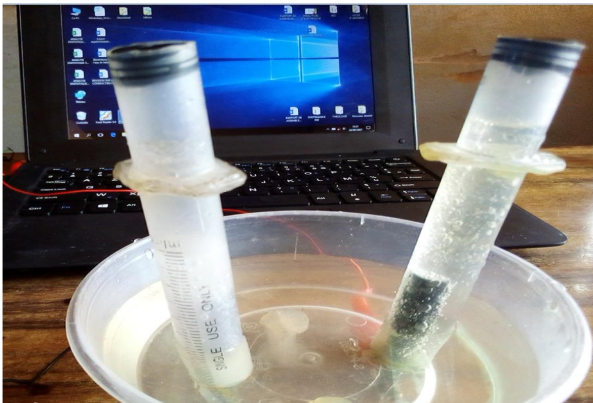
Figure 6 : Réaction de l'Électrolyse de l'eau
