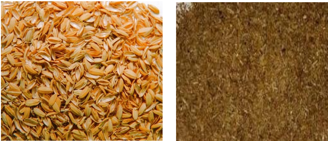
Figure 7 : Coques de riz et mélange coque-son de riz
