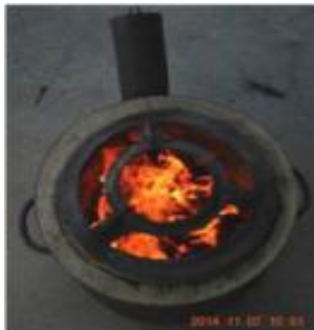
Figure 11 : Combustion des briquettes dans le foyer SALMAR
