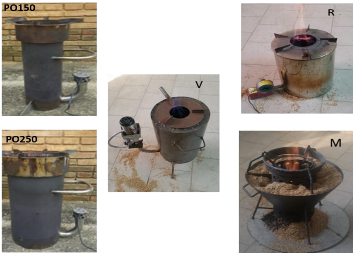
Figure 13 : Gazéificateurs à coques de riz
