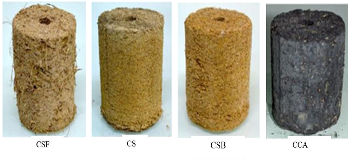
Figure 21 : Echantillons de briquettes (coque–son) consolidées par différents liants.
