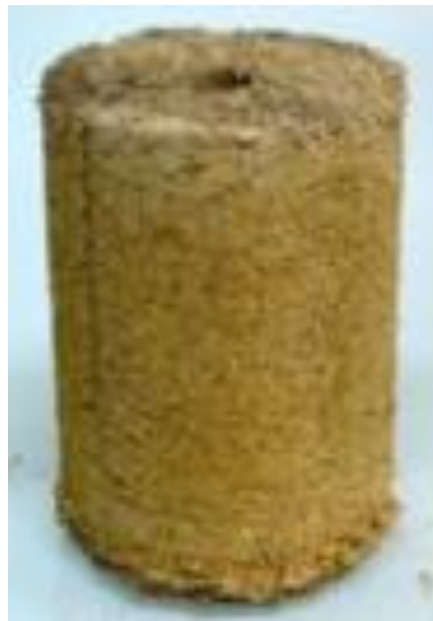
Figure 20 : Briquette à base de coque et de son de riz
