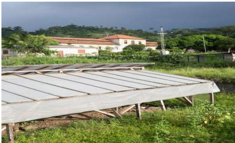
Photo11: Séchoir solaire hybride
