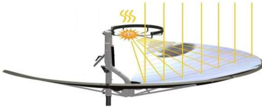
Photo 4 : Four solaire parabolique
