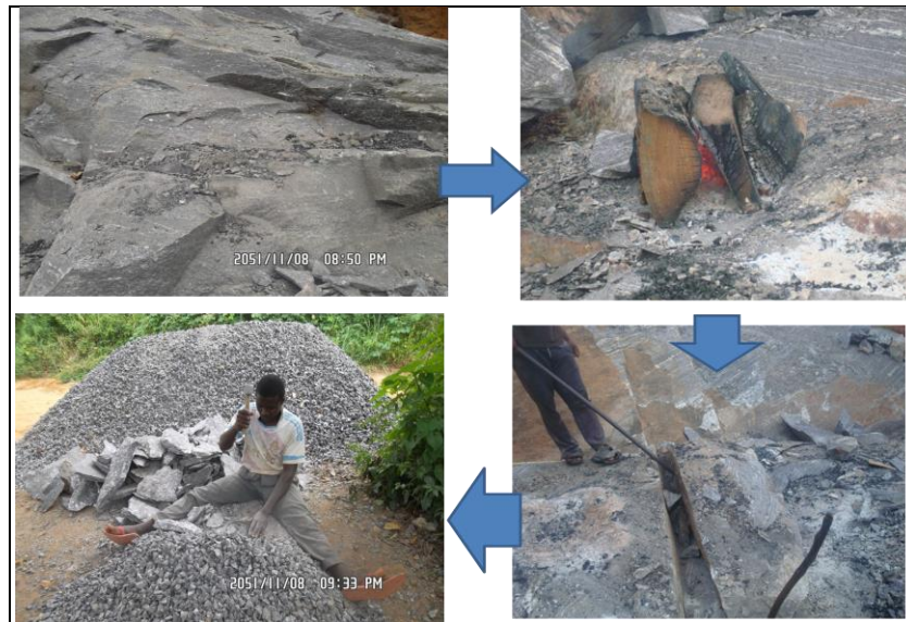
Figure 1.24: Processus d'abattage thermomécanique
