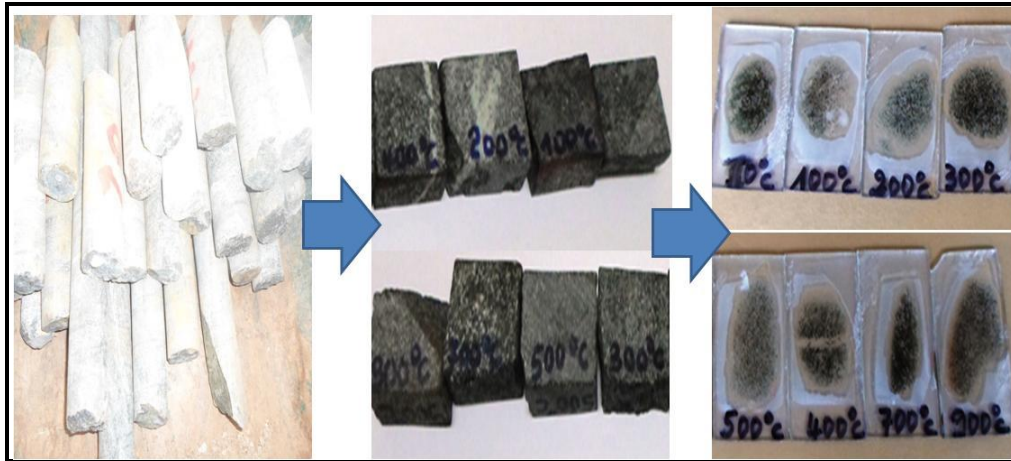
Figure 2.10 : Etapes de confection d'une lame mince de gniess
