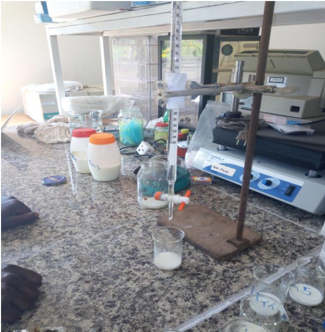
Mesure de l'acidité titrable du lait
