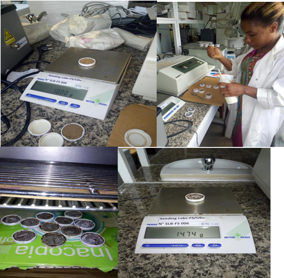
Détermination de la matière sèche totale du lait
