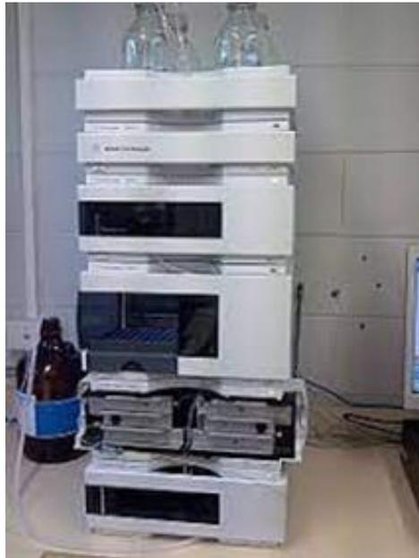
**Figure 33 :** HPLC utilisé pour détection des métabolites présents dans le milieu réactionnel après le contact entre l'insecticide et les protéines synthétisées en présence du glutathion réduit. (Source : Kouamo, 2020).
