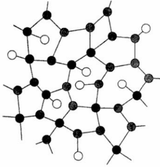
Figure 1.7 : Représentation du silicium amorphe hydrogéné. Les atomes de silicium sont représentés en noir et les atomes d'hydrogène en blanc [44].
