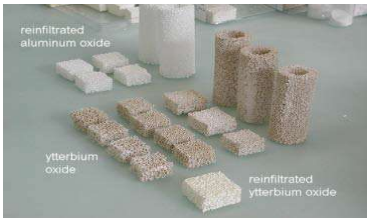
Figure 1.15 Des échantillons céramiques et quelques tubes des émetteurs céramiques (Antonio Marti and al, 2004)
