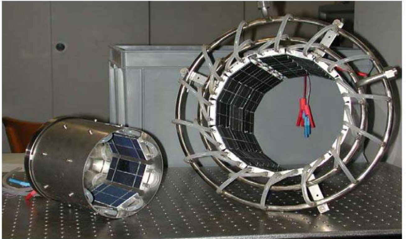
Figure 1.17 Le générateur de Cellule photovoltaïque pour le petit prototype (à gauche) et le système de démonstration (à droite) (Antonio Marti and al, 2004)
