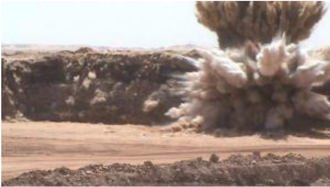
Figure II-4. Séquence de mise à feu (De Lile, 2012).
