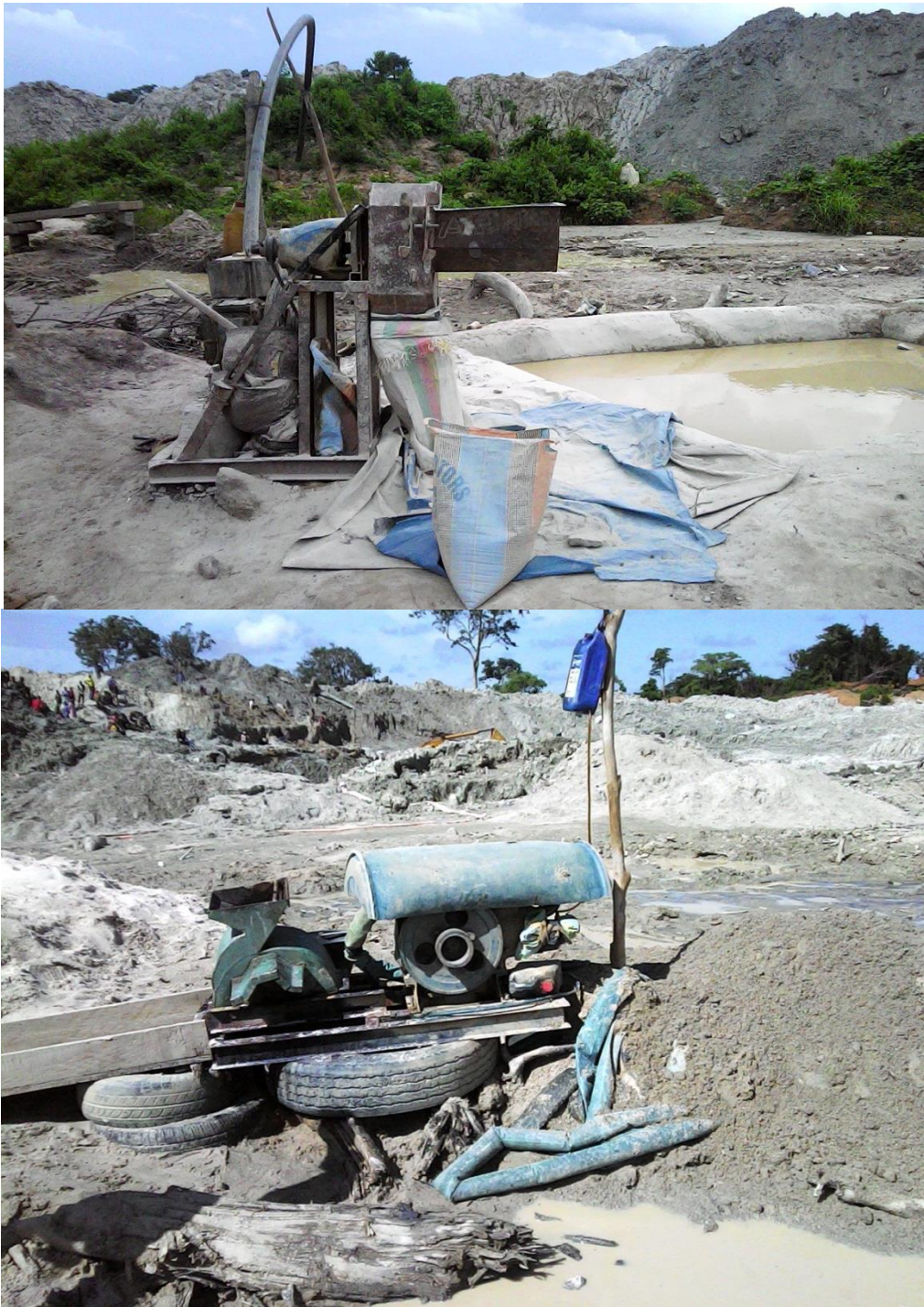
Photo 18 : Appareil local de transformation du minerai
