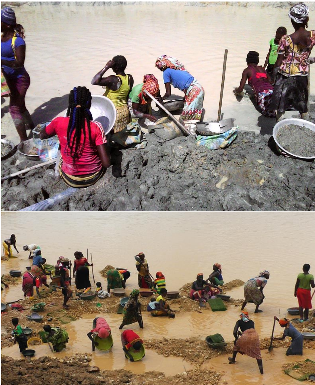
Photo 22 : Technique artisanale de batée à Kolomine
