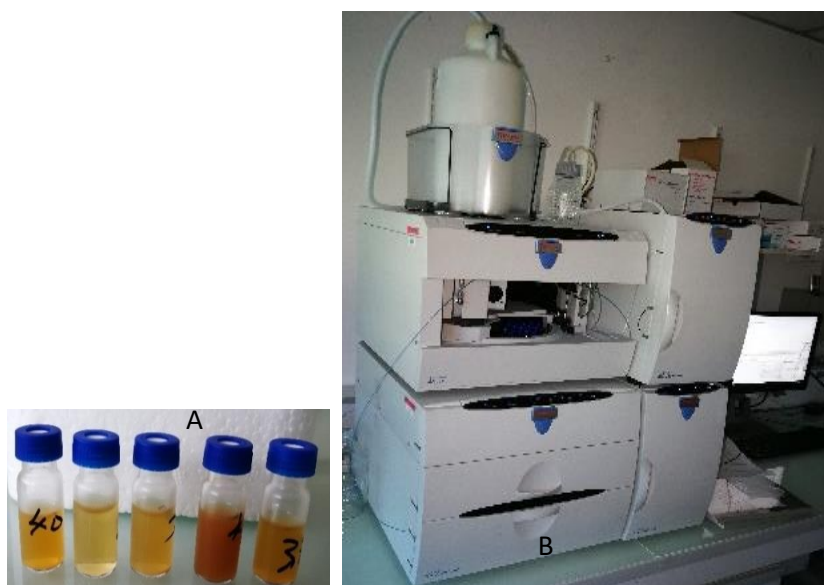
Figure 29: tubes à HPLC (Vials) (A) contenant des extraits solubles d'acides aminés et appareil de HPLC (B) pour analyse des extraits ou standards (Cliché AKOA, 2021)
