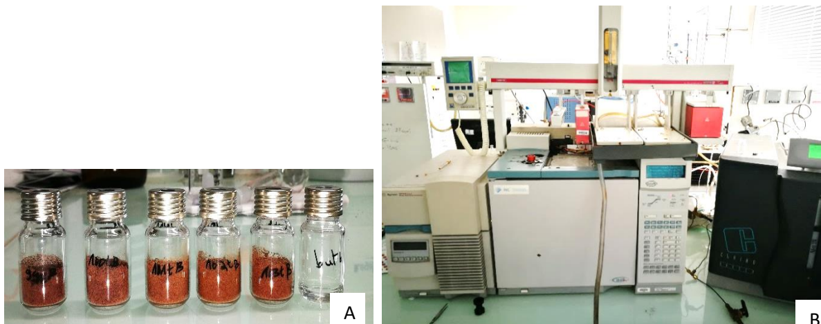
Figure 32: tubes (vials) hermétiquement fermés contenant les poudres des différentes matrices (A) et dispositif SH-SPME-GC-MS pour l'extraction et analyse des composés volatils (B)
