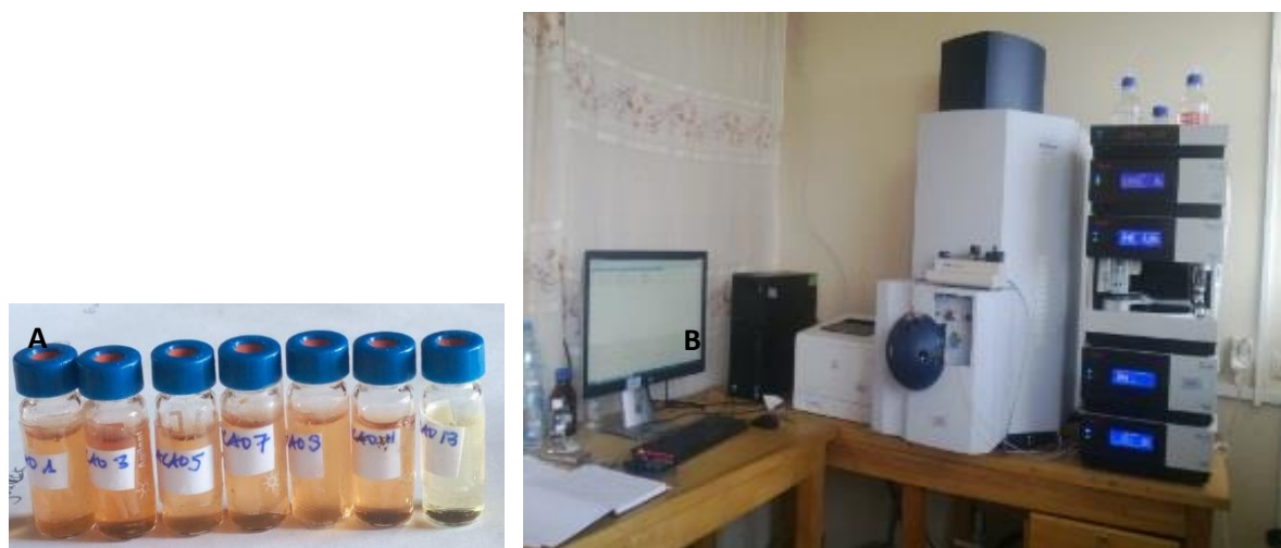
Figure 28: tubes à HPLC (Vials) (A) contenant des extraits bruts de polyphénols des fèves ou standards et dispositif UPLC-DAD-ESI-MS TOF (B) (Cliché AKOA, 2020)
