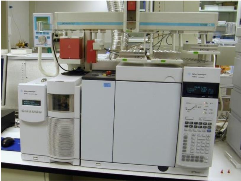
Annexe 4 : Appareil d'analyse CPG/SM Agilent Technologie, 7890A
