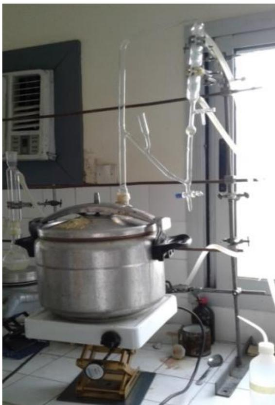
**Figure 14:** Dispositif d'hydrodistillation de type clévenger (photo : Kouassi 2020)
