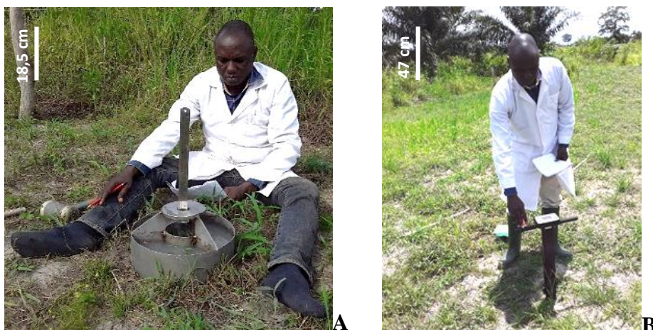
Figure 17 : Mesure de l'infiltration, de l'humidité et de la température A : Mesure de l'infiltration avec infiltrmètre à double anneaux ; B : Mesure de l'humidité et de la température du sol avec l'humidimètre TDR 350
