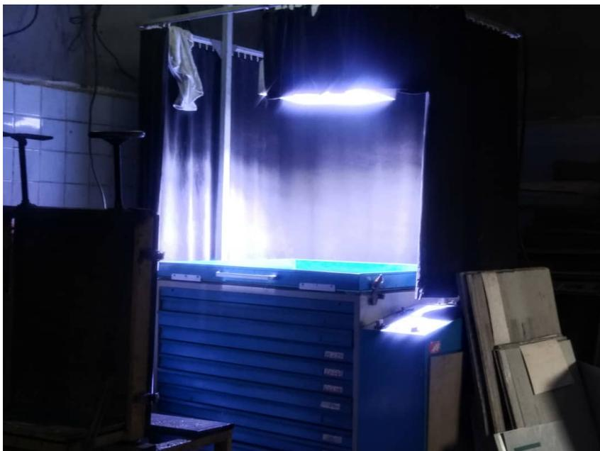
Image d'une insoleuse émettant un rayon ultraviolet.
