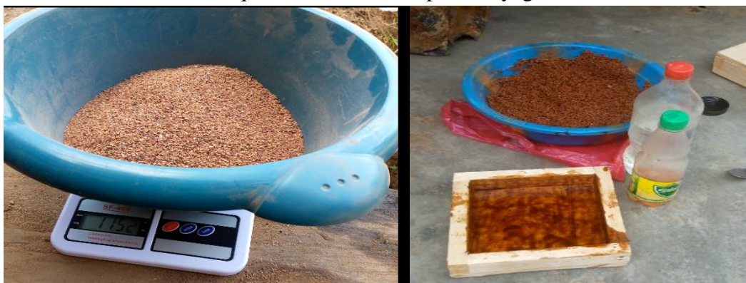
2. Mesure et préparation du mat (résines + renforts)
