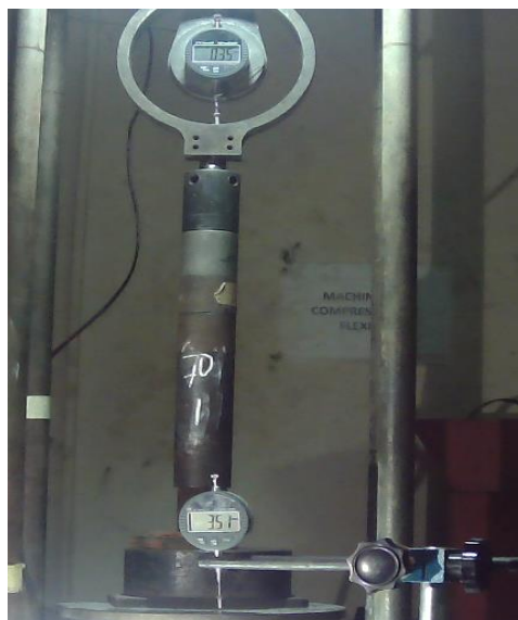
Figure II -14 : Dispositif pour l'essai de compression perpendiculaire.
