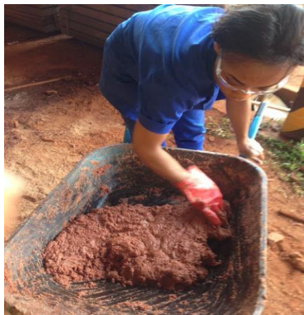
Figure 8 : Mélange liant (amidon de manioc) et sciure Sapelli
