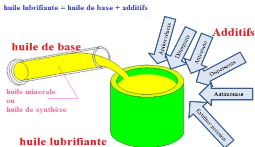
*Figure 1.3 : La composition des huiles lubrifiantes des moteurs [7]*
