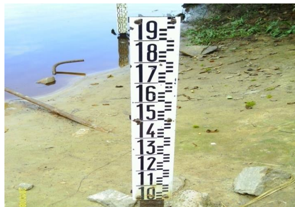
Figure II.4 : Batterie verticale d'échelles limnimétriques en palier à la station de Pana sur la Kadey (Cliché Kouassy Kalédjé, 11 septembre 2015)
