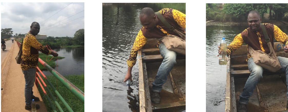
Figure II.8 : Technique de prélèvements des eaux d'écoulement : (a) Sur une même verticale ; (b et c) par immersion d'un flacon directement dans le lit du cours d'eau ( Cliché Kouassy Kalédjé, 17 mars 2015 )
