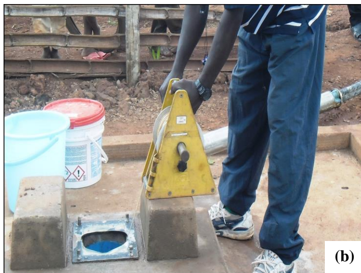
Figure II.7 : Opérations de mesures des niveaux statiques de la nappe d'eau en vue de la détermination des niveaux piézométriques : a) Sonde électrique et sonore ; b) Opération de la mesure des niveaux statiques ( Clichés Kouassy Kalédjé, 24 novembre 2015 ).
