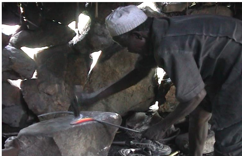
Photo N° 2 : fabrication du couteau de jet par un forgeron
