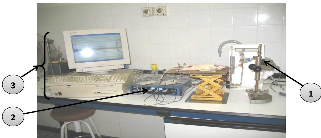
Figure 5: Dispositif d'enregistrement de la pression artérielle et de la fréquence cardiaque (Photographie prise par TCHOUPOU au laboratoire de Physiologie Animale)
