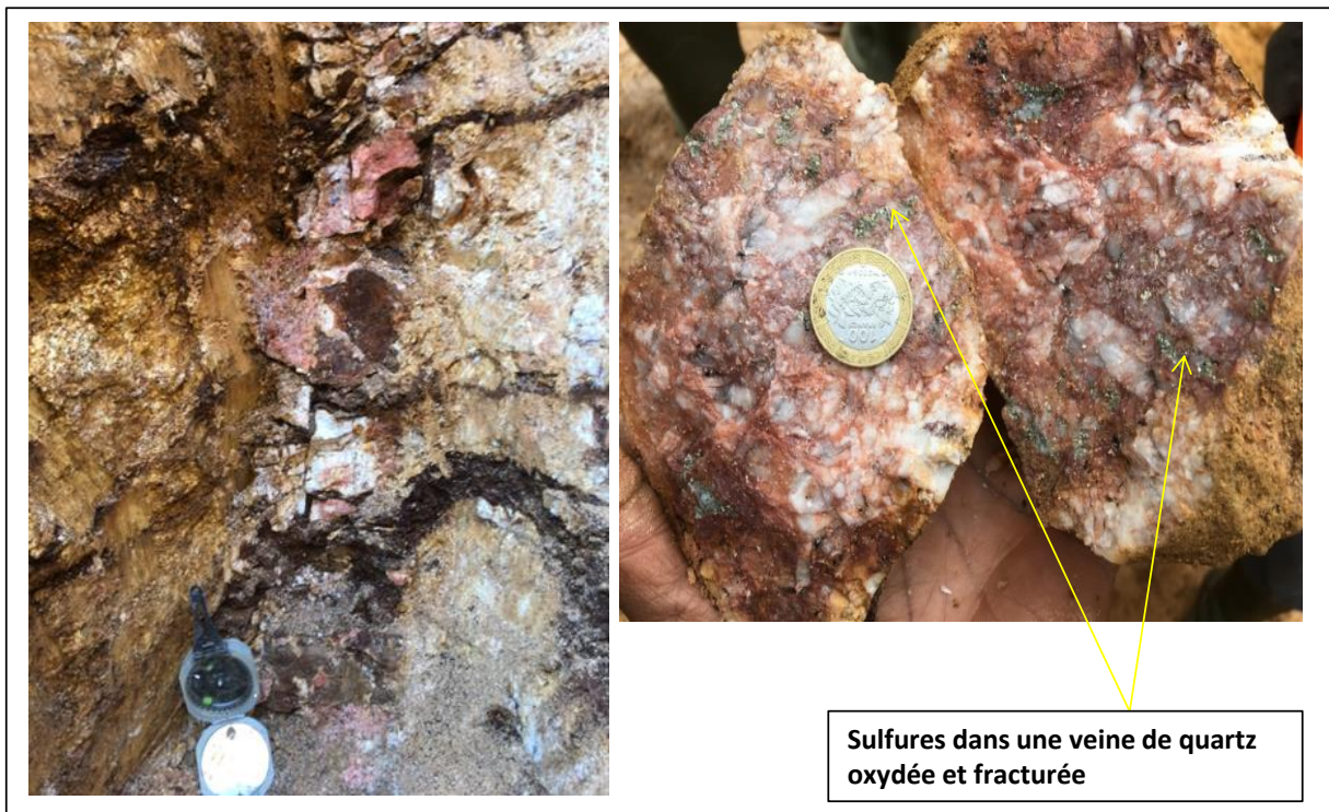
Figure 43: Gravier minéralisé (veines de quartz oxydés) dans le secteur de Garga Sarali (à gauche). Un échantillon de veine de quartz oxyde et fracture (à droite).
