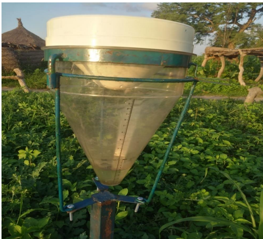
Photo 13 : pluviomètre pour connaître le niveau d'eau de pluie par an prise sur la route de Guibéré.
