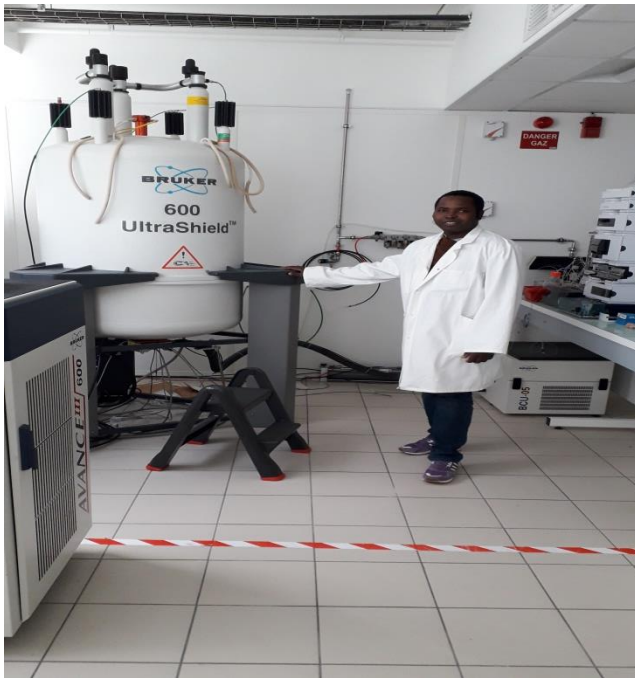
Photographie 2 : Appareil de résonance magnétique nucléaire (BAIRY, 2019, Bordeaux, France).
