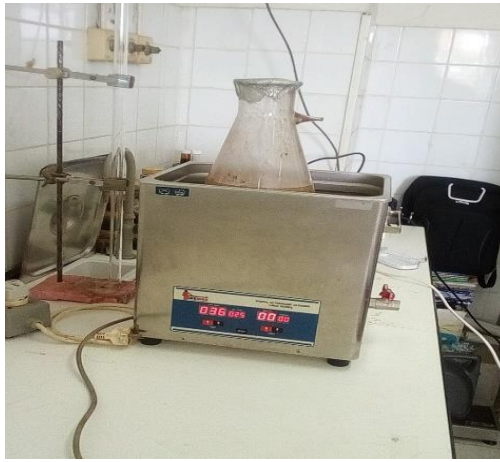
Photographie 4 : Le bain ultrason (le sonicateur).
