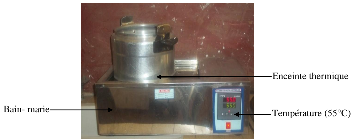
Photographie 10 : Dispositif de plaque chauffante
