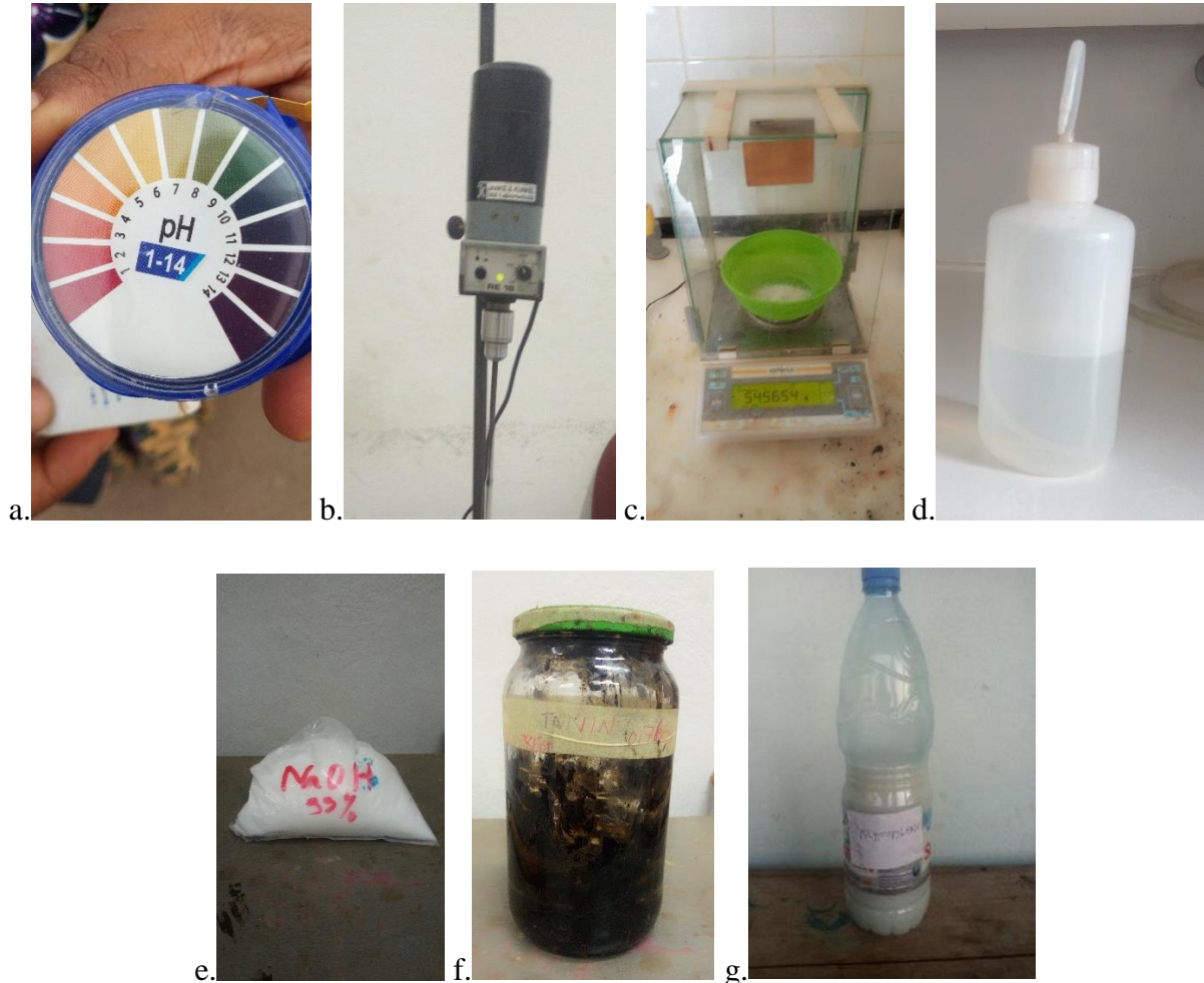
Photo 2-10 : Matériel utilisé pour formulation de la résine ; a) papier PH, b) Agitateur mécanique, c) balance de précision, d) Eau distillée, e) Hydroxyde de sodium, f) Tannin, g) Latex.
