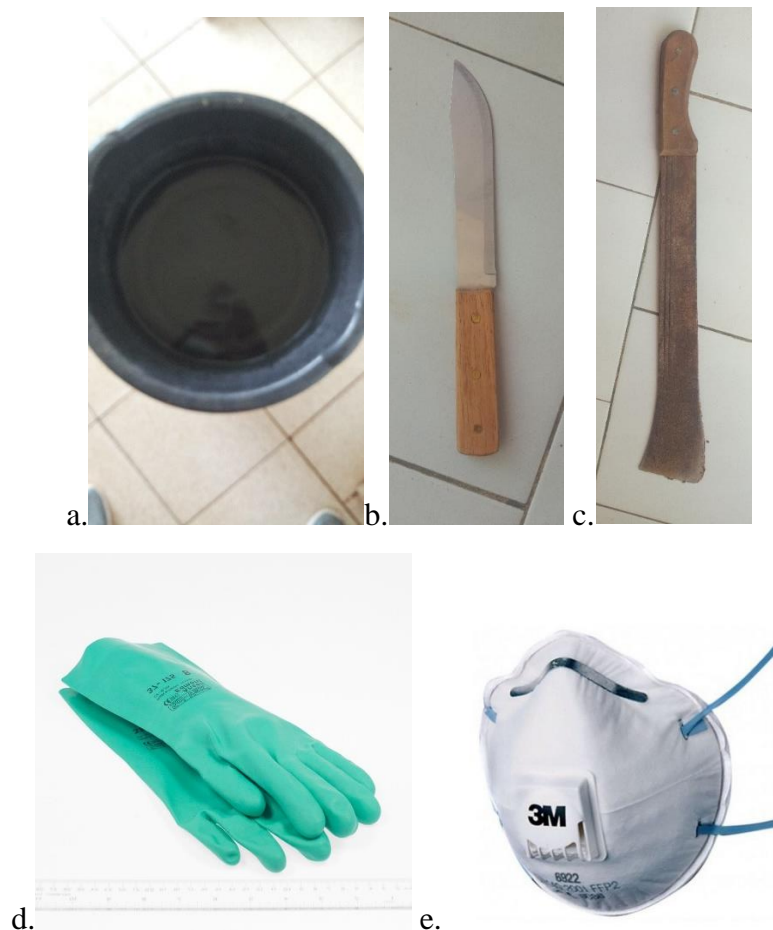
Photo 2.7 : matériels utilisé pour l'extraction des fibres du pseudo-tronc de bananier ; a) Bassine avec de l'eau, b) Couteau, c) Machette, d) Paire de gants, e) cache nez
