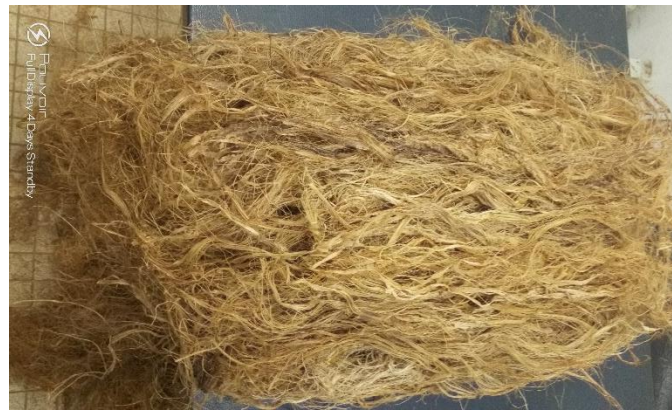
Photo 3-1 : Fibres extraite du pseudo-tronc de bananier par la méthode de rouissage biologique
