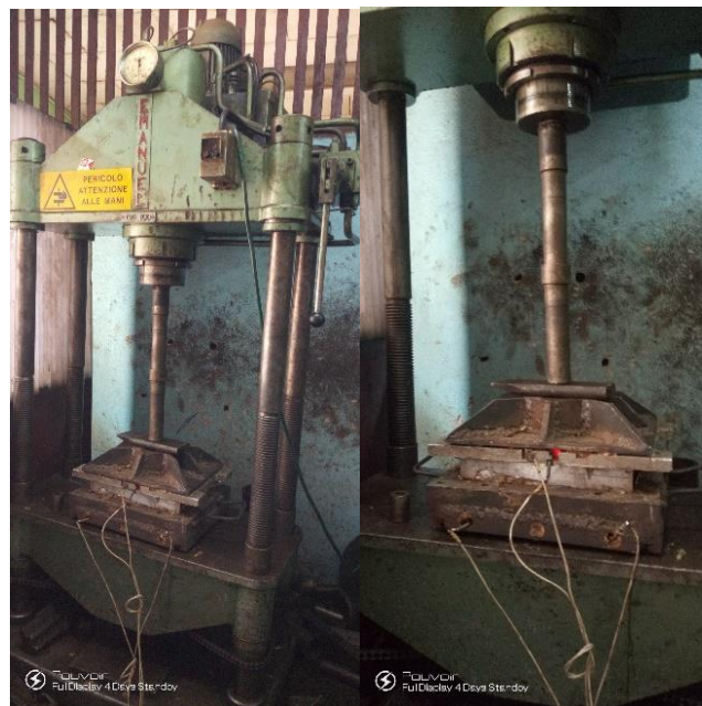
Photo 2.18 : ensemble en cours de pressage
