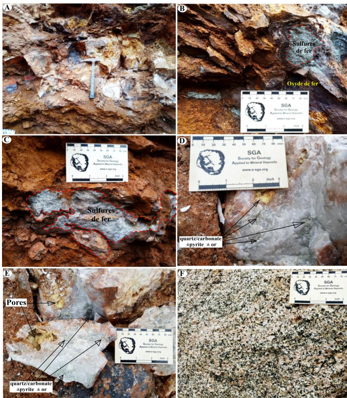
Figure 6.26. Évidences de terrain de la minéralisation aurifère et de l'altération hydrothermale associée. A) Veine de quartz aurifère très fracturée et altérée ;B) Sulfures de fer (pyrite, chalcopyrite et pyrrhotite) disséminés dans la paroi rocheuse en cours d'altération ; C) Couche de sulfures (pyrite et chalcopyrite) massifs ; D) Veine de quartz minéralisée à proximité de Boden et de Madubal; E) Veine de quartz aurifère à Colomines montrant des pores ; F) Boule de granite isolé dans le manteau d'altération: notez l'altération potassique.
