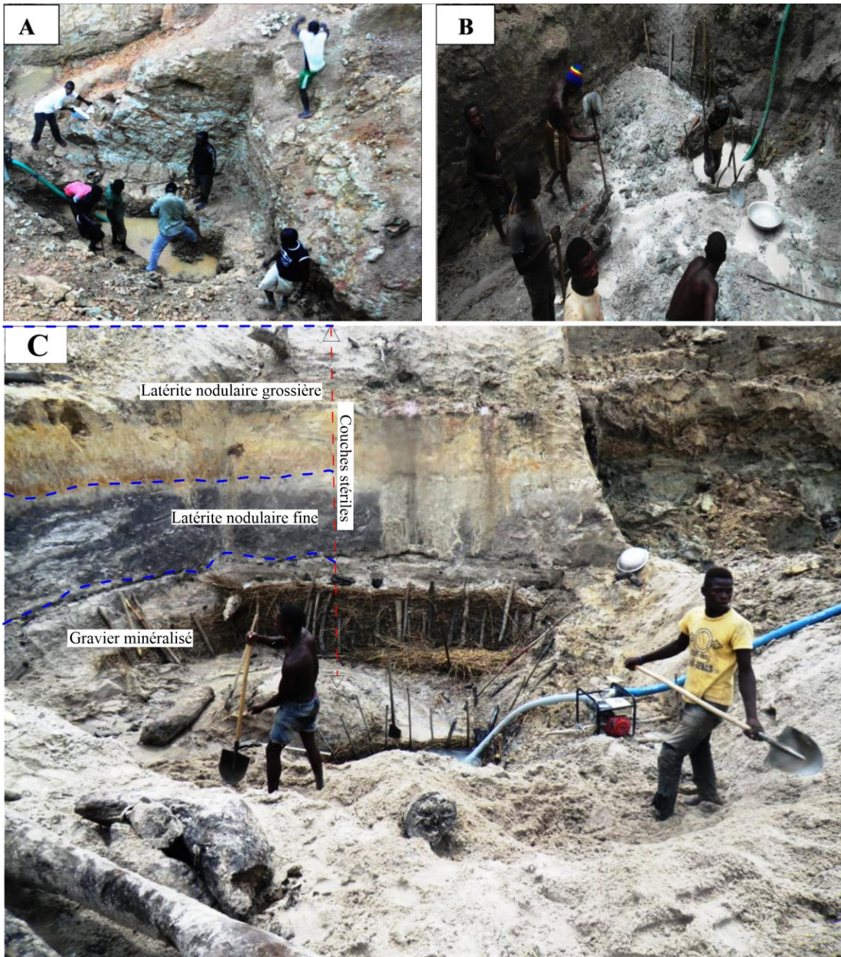
Figure 6.1. Sites d'exploitation artisanale d'or montrant des puits d'échantillonnage à Colomines (A) et le long de la rive de la rivière Kadei (B et C). Notez la position relative des couches de gravier stérile (gangue) et minéralisée ainsi que leurs épaisseurs en C).
