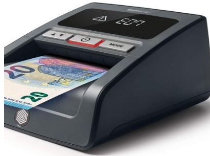
Figure 10: Vérification par lumière infrarouge [7]
