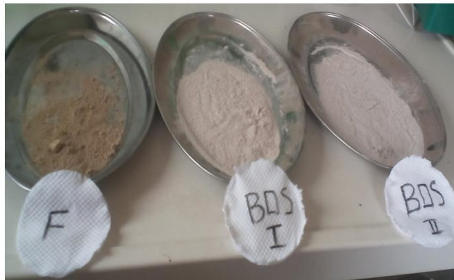
Photo 22 : Photos montrant la présence ou l'absence des grumeaux dans différents formulations après dix mois d'exposition à température ambiante.
