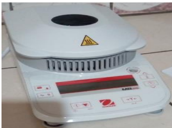
Photo 17: Photo de l’hygroscomètre (Photographié par Tene, 2018)
